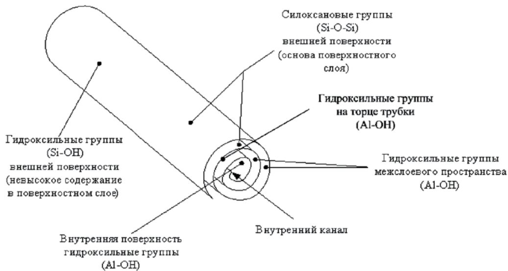
Рис. 1. Схематичное изображение многослойной трубчатой структуры алюмосиликатных нанотрубок.
